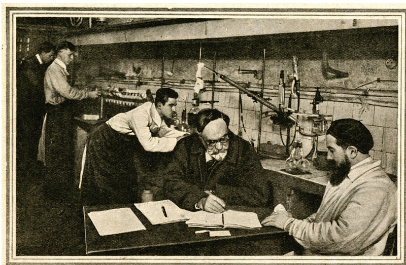
L'étude de nouveaux corps organiques, de nouvelles méthodes de préparation est également l'objet de recherches très assidues de M. Moureu et de ses collaborateurs. Voici une salle spécialement affectée à ces études. Nous voyons derrière M. Moureu et son chef de laboratoire, M. Dufraine, deux élèves à gauche qui dosent le carbone et l'hydrogène, un autre à droite qui fait une distillation fractionnée dans le vide.
