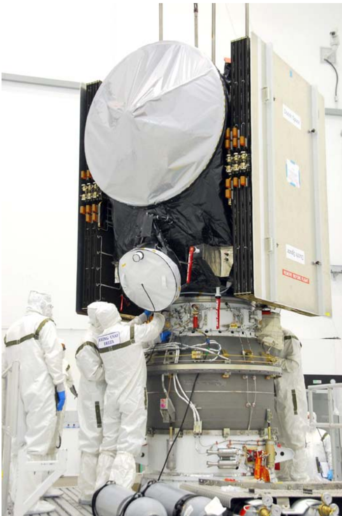
Fig. 3. Montering og klargjøringen av Dawn på festeplattformen for det øverste og tredje trinnet av bæreraketten som sendte Dawn ut i verdensrommet (Foto: NASA)
