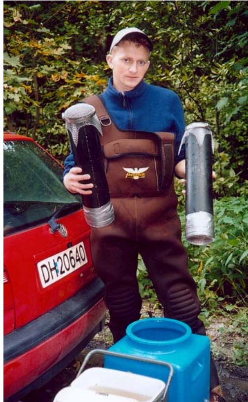
Figur 6. Sylinderbur plassert i Alna. Maskevidde i enden 5 mm, rørdimensjon 10 cm diameter, lengde 50 cm.
