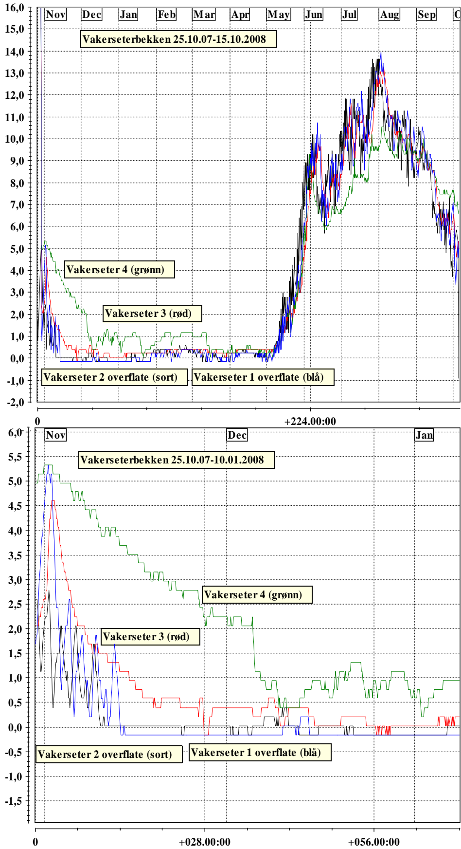
Fig. 2. Temperatur målt hver 3 time på 4 punkter i Vakerseierbekken. Over: Perioden 25.10.2007 – 15.10.2008. Under: 25.10.2007 – 10.01.2008.
