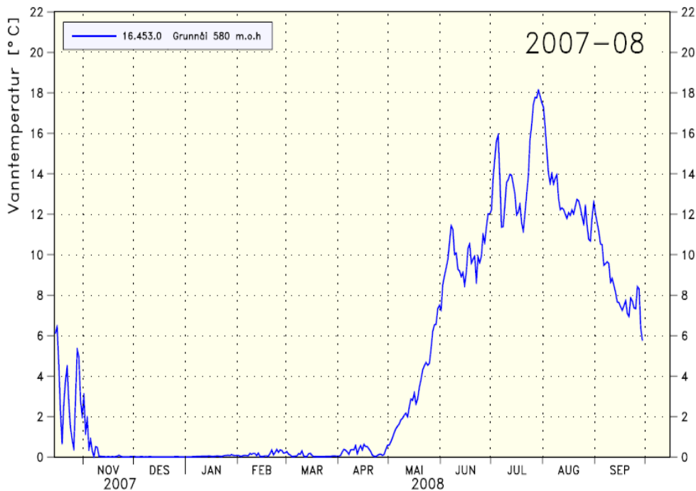
Fig. 3. Temperatur i Grunnåi, 580 m oh. nordvest for Seljord i perioden 15.10.2007 – 1.10.2008. Vassdraget er ikke grunnvannspåvirket og viser høyere sommertemperatur og lavere vintertemperatur enn Vakerseterbekken.
