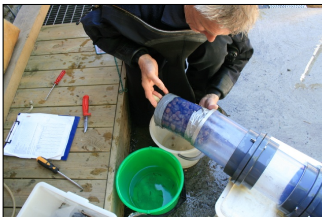
Figur 2. Forsøksoppsett for undersøkelse av laksungenes bruk av bunnsubstrat. I hvert av de tre rørene på 100 cm, diameter 16 cm, er det fem seksjoner á 20 cm, diameter 14 cm, hvorav de tre i midten hadde substrat, mens de to i hver ende ikke hadde substrat. Ved forsøksstart ble fisk plassert i endeseksjonene.
