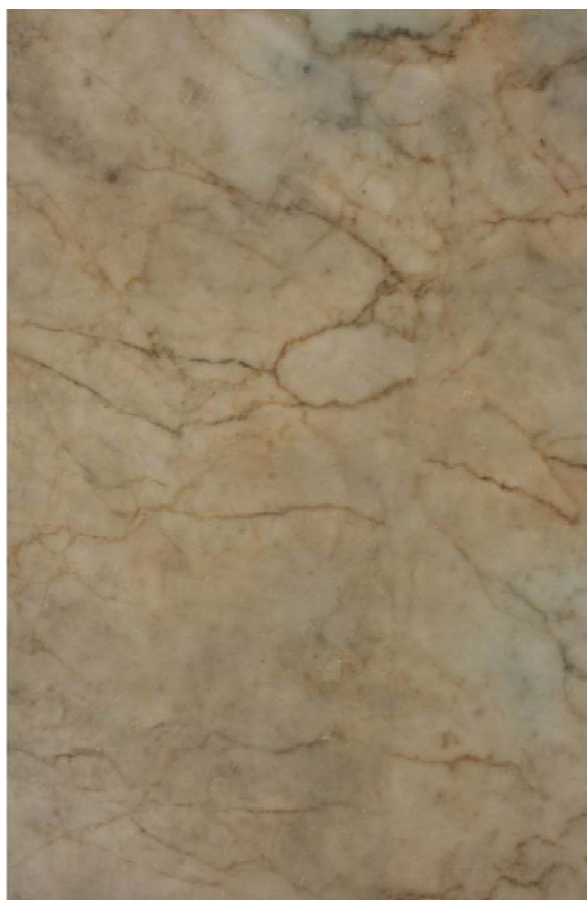
Figur 6. Øverst: Prøvetaking ved å skrape misfarget belegg av plan marmorflate. Nederst: misfargingen er ujevn og varierer med marmorens struktur/tekstur. Foto: E. Roaldset 22.03.2013.
