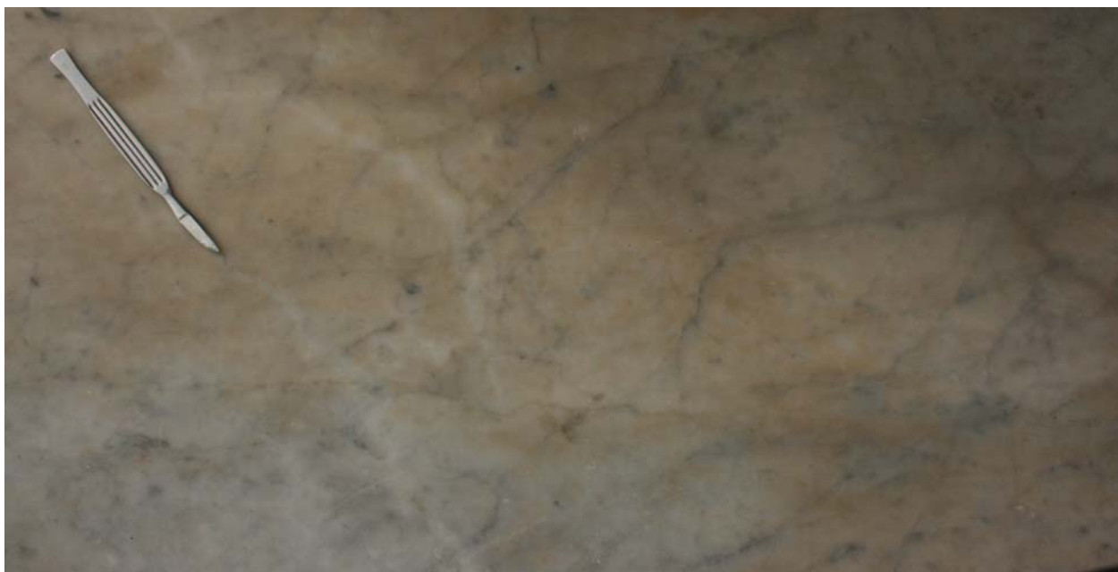
Figur 8. Kvartsrike soner i marmor. Sonene har lav porøsitet. Kvarts er dessuten mer bestandig enn kalsitt. Dette viser at misfargingen også avhenger av mineralogien. Foto: E. Roaldset 25.03.2013
