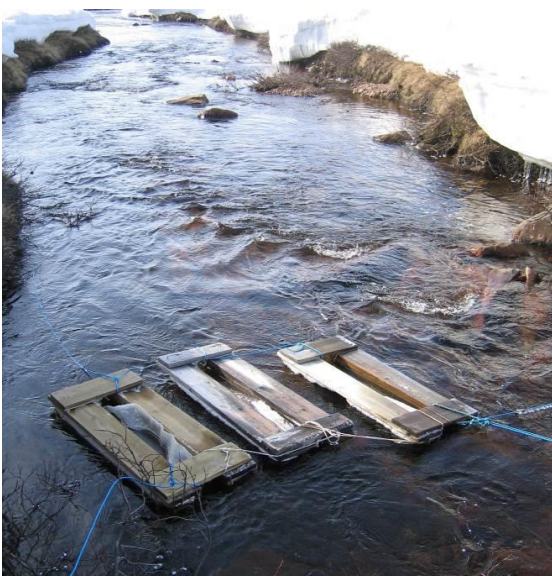
Figur 18b. Feller til innsamling av tilført plantemateriale under vårflommen i Brurskardbekken, innløpet til Øvre Heimdalsvatn. Foto: John Brittain.
